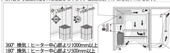
A：給気口の設置場所。機械式の換気装置を使用される場合は、給気パイプはヒーターから 50cm 以上の高さに配置する必要があります。自然対流による換気の場合、ヒーターの下部もしくは隣接する場所に給気口を設置してください。給気口のパイプ口径はΦ50-100mm としてください。
